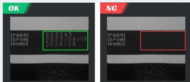
检测打印区域内字符颜色的面积，以识别有无三期
